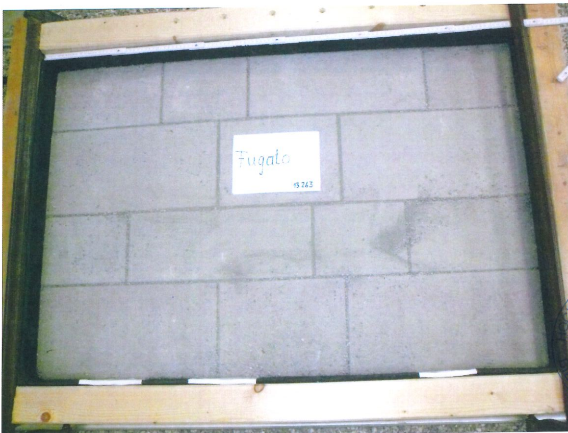
Bild 2: Vorgeschlagene Musterfläche des Pflastersteinsystem „Fugato“ Steinhöhe 60 mm, verlegt im Läuferverband
