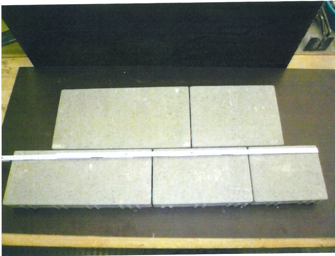
Bild 1: Pflastersteinsystem „Fugato“, Draufsicht Pflastersteine, Steinhöhe 60 mm, Fugenbreite ca. 4 mm
