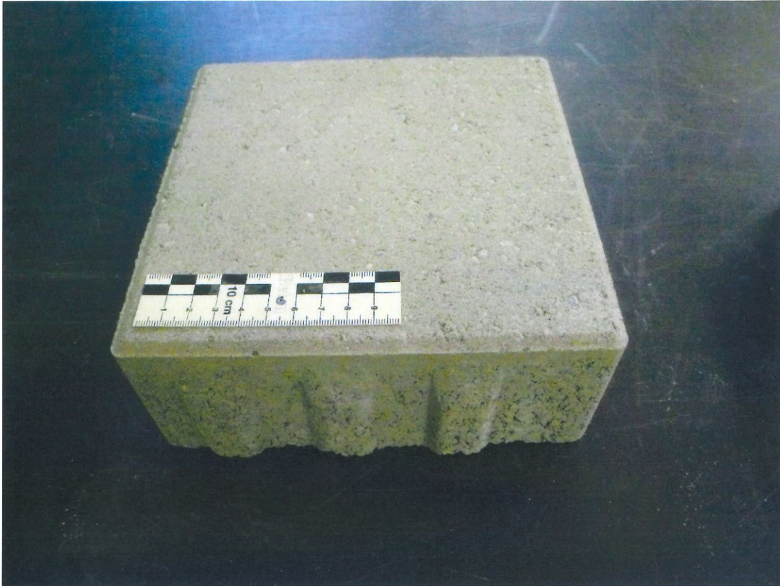
Bild 1: Betonpflastersystem „Eurovano“, Seitenansicht Pflasterstein, Steinhöhe 80 mm, mit ausgebildeter Rundum-Verzahnung
