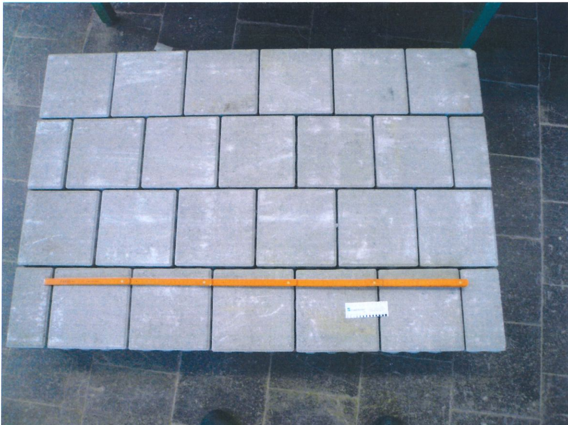
Bild 2: Vorgeschlagene Musterfläche des Betonpflastersystems „Eurovano“ Steinhöhe 80 mm
