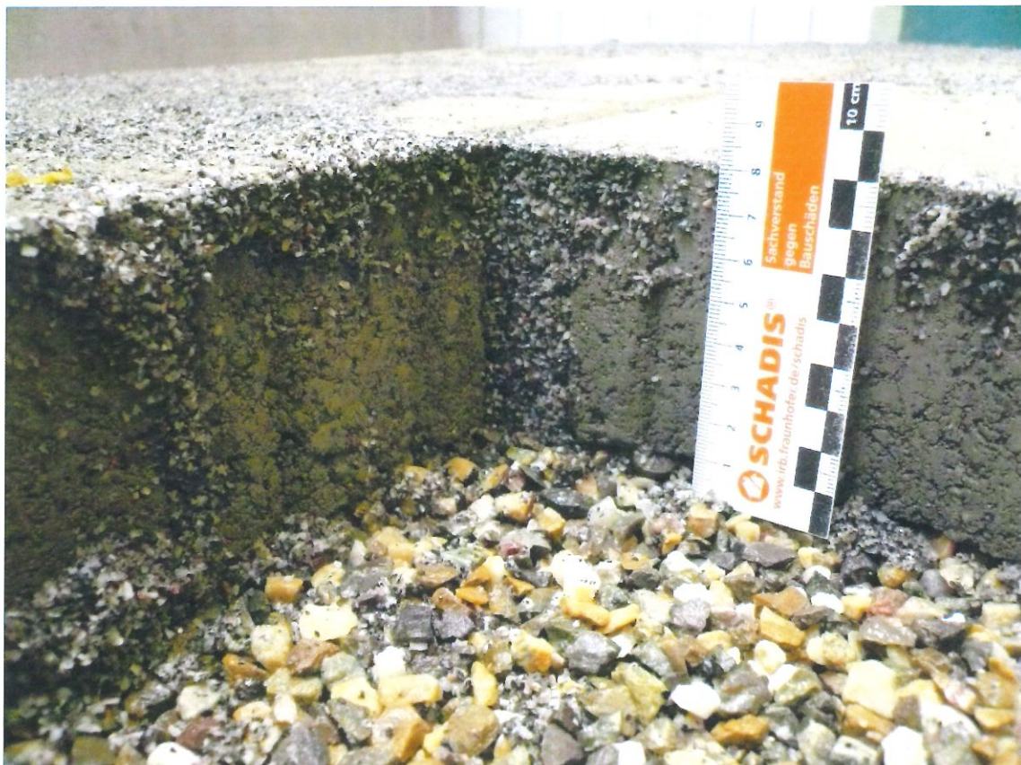
Bild 6: Detailansicht, Fuge nach Bewässerung
