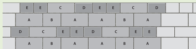
Verlegemuster mit getauschten Steinen (E und D sind gegeneinander austauschbar).
