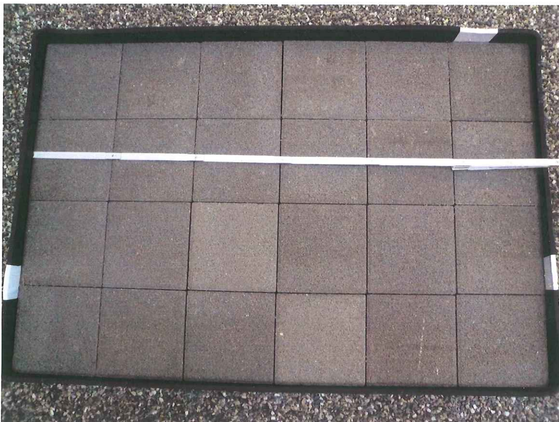
Bild 2: Vorgeschlagene Musterfläche des Sickerpor - Pflasters
