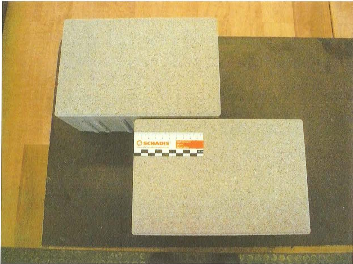
Bild 1: Pflastersteinsystem „Sarina“, Draufsicht Pflastersteine, Steinhöhe 120 mm, Fugenbreite 3 mm
