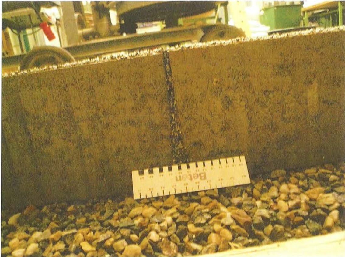
Bild 5: Detailansicht, Fuge nach Bewässerung
